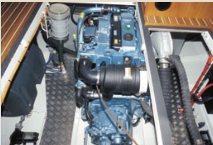
De motorruimte herbergt een viercilinder Perkins dieselmotor, die 86 pk levert bij 2200 toeren per minuut.
