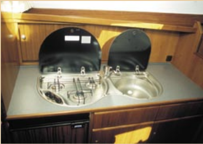
De kombuis met spoelbak en driepits gaskomfoor.
