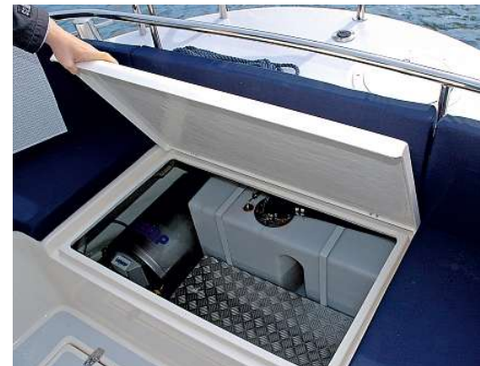
An den Deckeln der reichlich vorhandenen Staukästen fehlen geeignete Arretierungen
