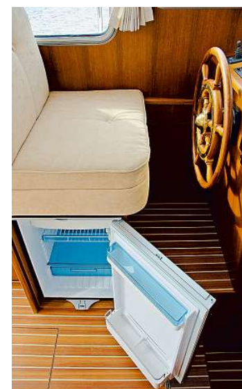
Kühlschrank-Montage unter dem Skipper'sitz
