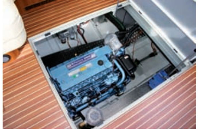
Saubere Installation des Perkins Sabre Diesel mit einer Leistung von 109 kW (148 PS).
